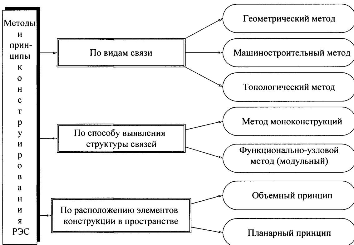
Рис. 11. Классификация методов и принципов конструирования РЭС
