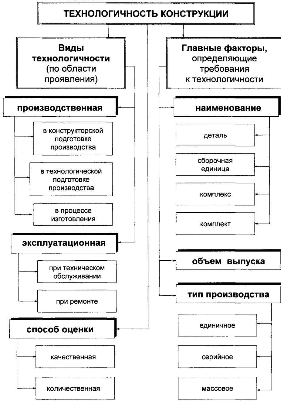
Рис. 6. Виды технологичности и факторы, определяющие требования к ней
