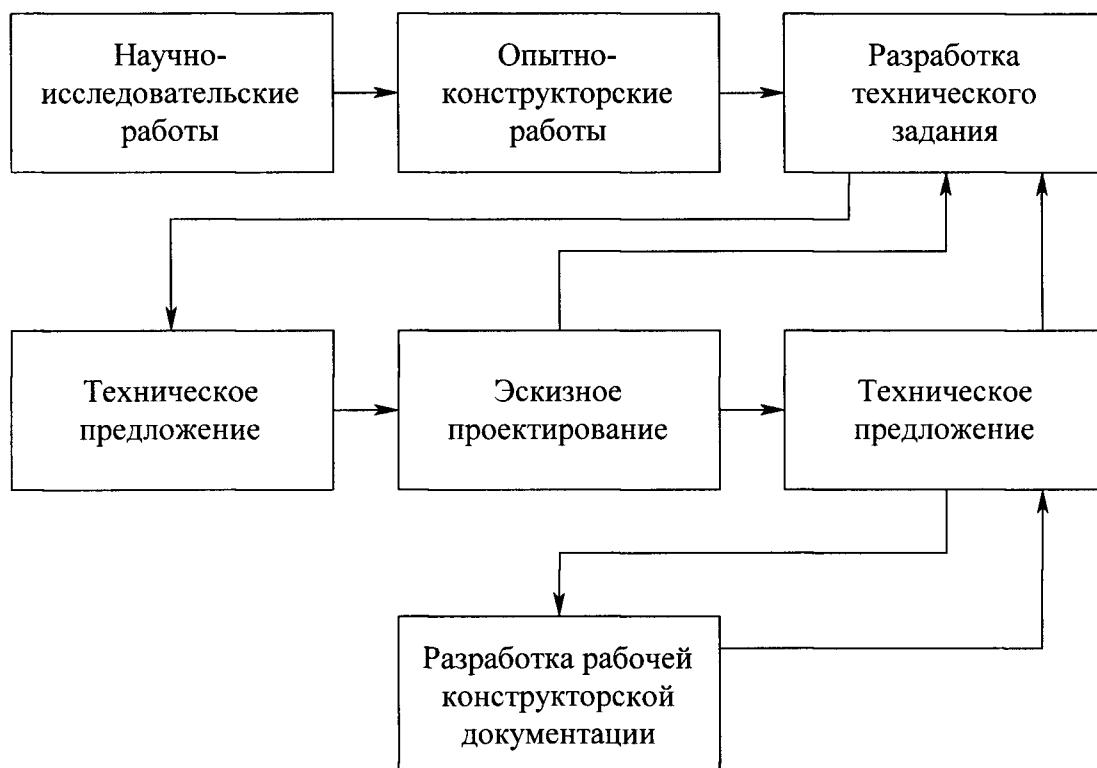
Рис. 8. Последовательность проведения проектно-конструкторских работ
